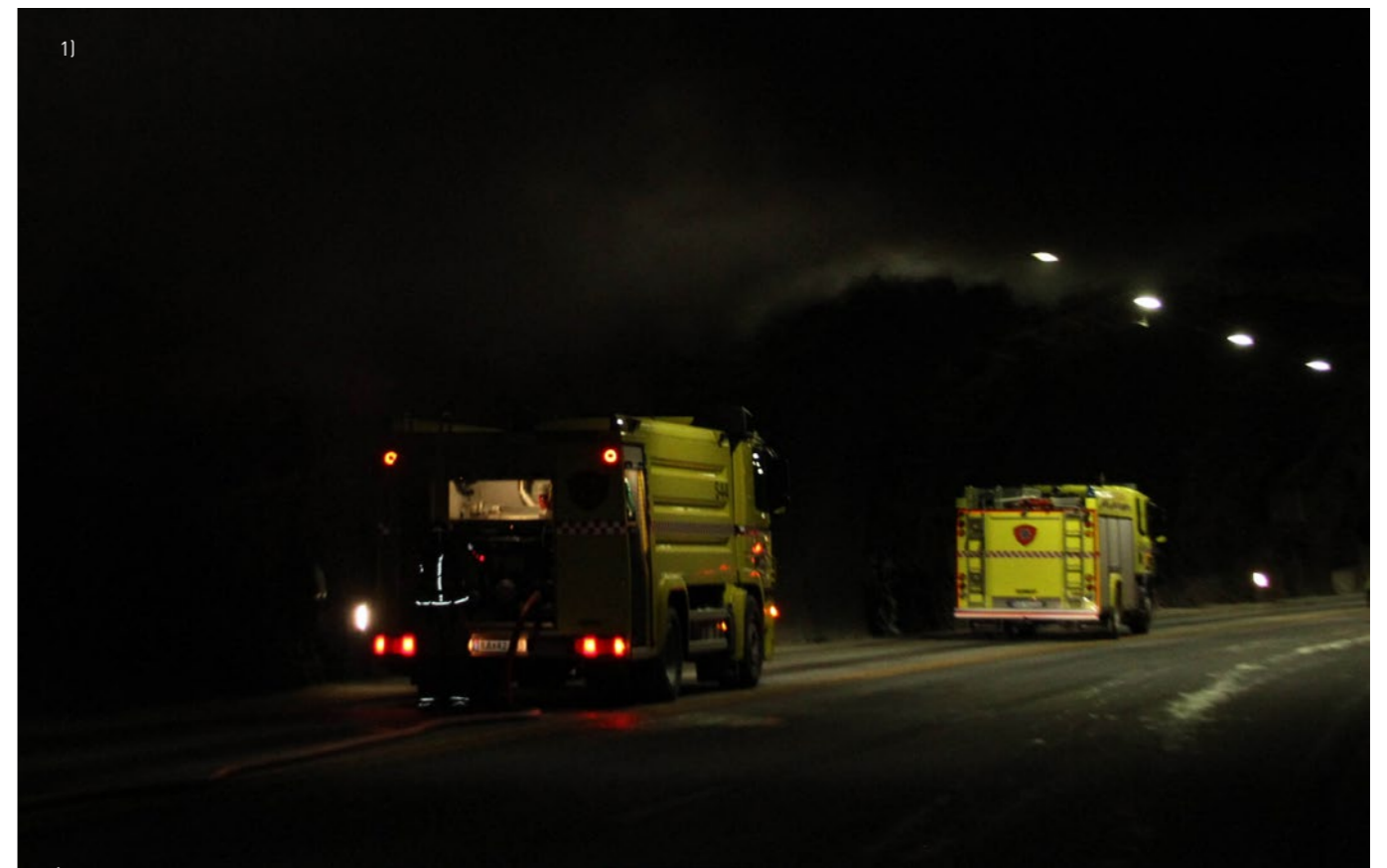
1) Bildet viser røykspredning i tunneltak under øvelse i Rennfast. Røyken fra brann spres seg mot vifteretning, som vises i taket. Bildet er tatt før røyventilasjonen er iverksatt. Røyken legger seg over taket på brannbilene og dekker etterhvert lysene i taket.
